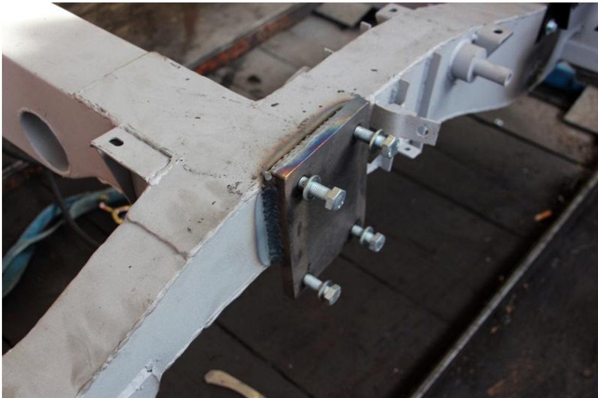
Noch bevor der Rahmen lackiert wird, wurde die Verstärkungsplatte für die Servolenkung eingeschweißt.
