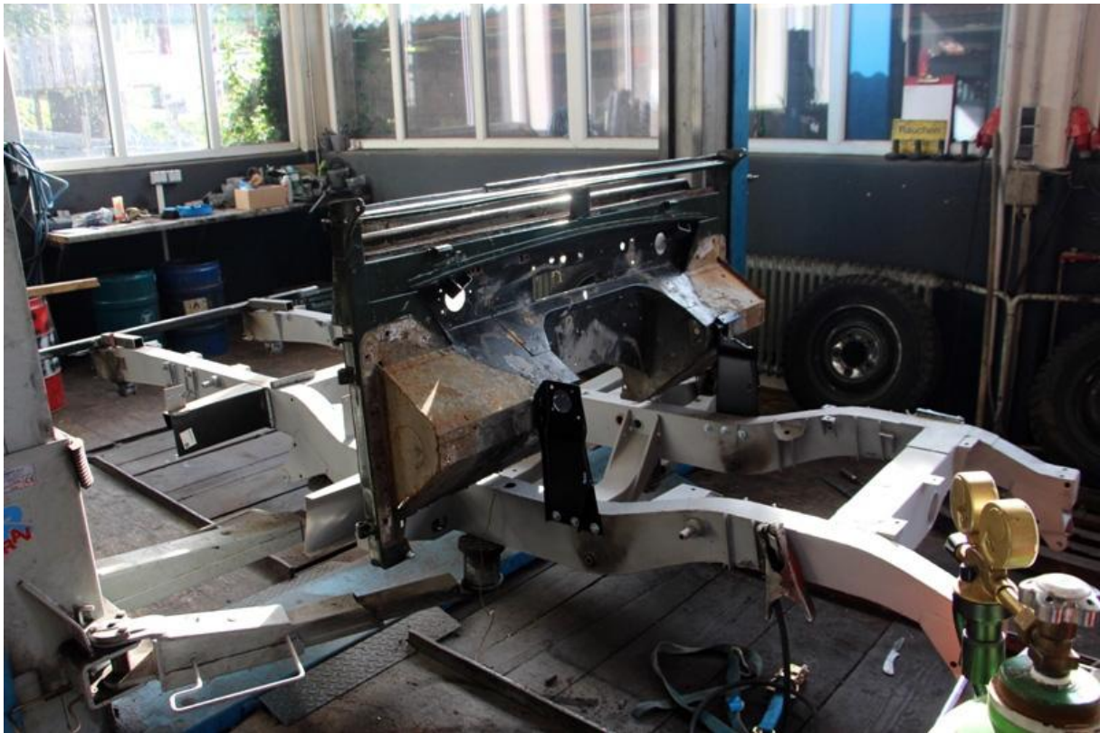
Noch bevor der Rahmen lackiert wird, wurde die Verstärkungsplatte für die Servolenkung eingeschweißt.
